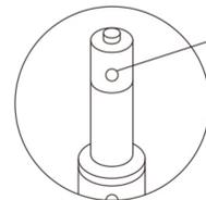
ボールの廻り止めビスがシマ設備の正面に向くよう向きを調整します。
