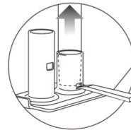
抜きジグを押し込み、テコを利用するとボールが浮上するように抜けます。
