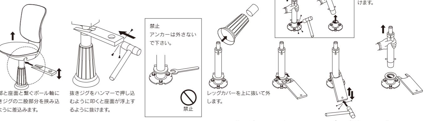
抜きジグをハンマーで押し込むように叩くとポールが浮上するように抜けます。
