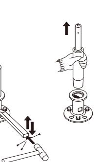
抜きジグをハンマーで押し込むように叩くとポールが浮上するように抜けます。
